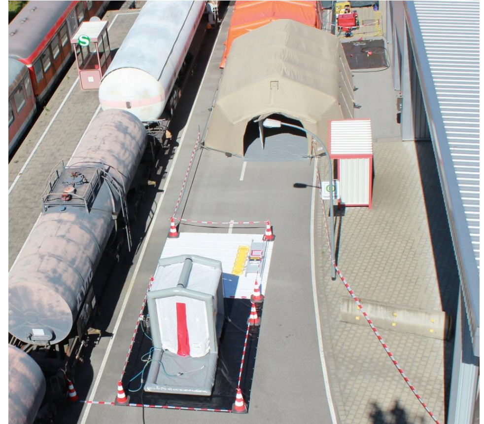
GW Dekon P mit Trinkwassertanks, Trinkwasserfaltbehälter, Ankleidezelt, Technikbereich, Duschzelt, 5000 l Abwasserbehälter, Dekon V-Zelt, Standarddekonplatz mit Einzelpersonenduschkabine, provisorischer Abwasserbehälter
