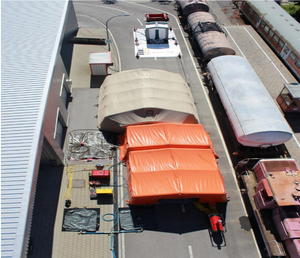
Trinkwasserfaltbehälter, Zeltheizgerät, Technikbereich, Ankleidezelt, 5000 l Abwasserbehälter, Duschzelt, Dekon V-Zelt, Standarddekonplatz mit Einzelpersonenduschkabine, provisorischer Abwasserbehälter
